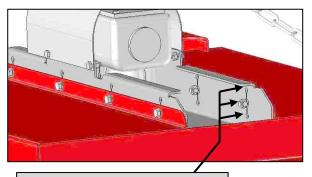
Adjusting of cutting height With 3 positions par déplacement du bloc support renvoi d'angle
